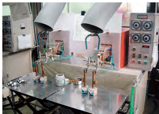
<高周波熱処理機（銀ろう溶接）>
