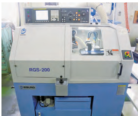
NC ローレット旋盤 RGS-200（エグロ）
